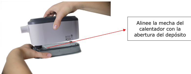
Figura 5 Alinee el cartucho del calentador con la abertura del depósito. Baje el dispositivo al depósito. Los imanes servirán para mantener las dos partes unidas.
