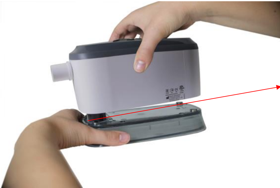
Figura 5 Alinee el cartucho del calentador con la abertura del depósito. Baje el dispositivo al depósito. Los imanes servirán para mantener las dos partes unidas.
